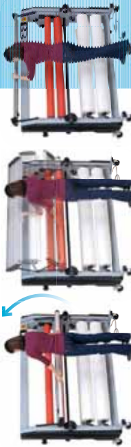
La bandeja de entrada de material es pivotante y se levanta totalmente dejando un completo y seguro acceso a la máquina mientras se carga el film. En esta posición superior, la marcha del motor está desconectada, previniendo al operador de cualquier daño durante la operación de carga.
